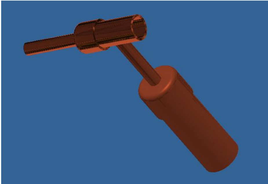
Obr. 4: válec parního stroje s válcem šoupátka
