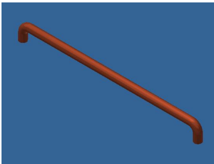
Obr. 7: Táhla jsou vyrobená z měděného drátu, ocelového pásku a drátu z výpletu kola
