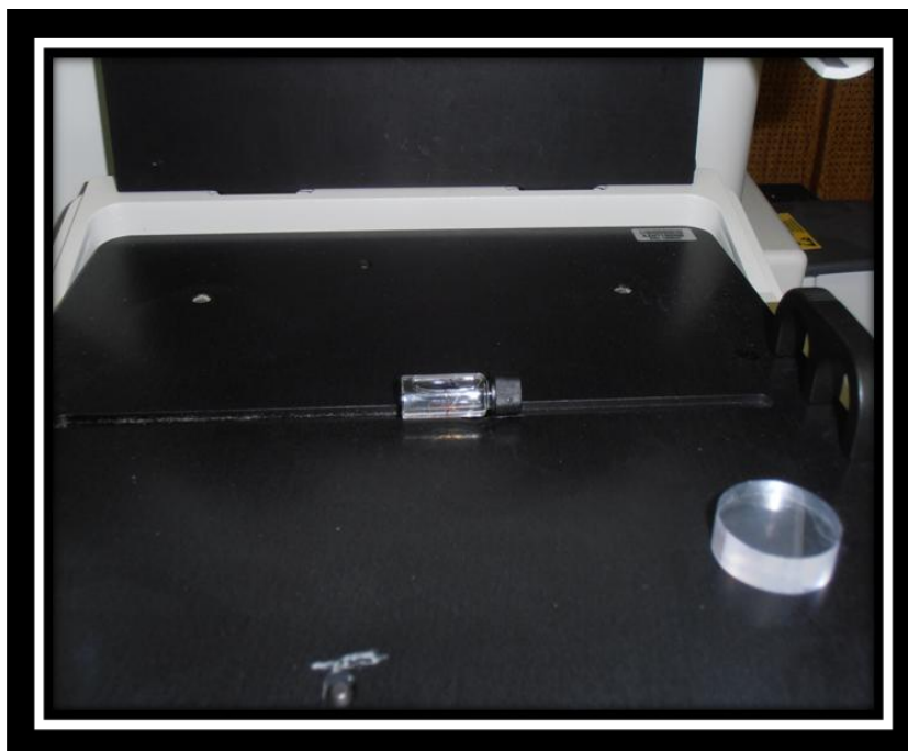
Příloha č. 9 - Obrázek č. 5 - Ukázka vzorku při Ramanově spektroskopii
