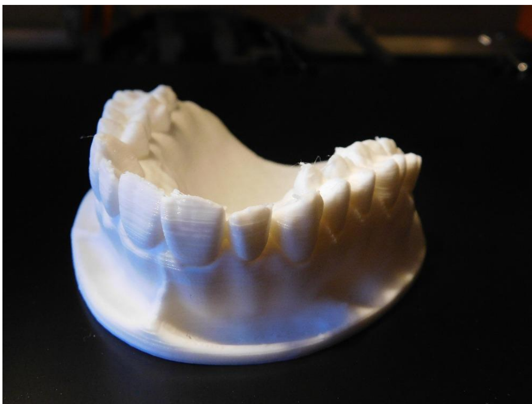
Obrázek 9 a 10: Začátek tisku a hotový tisk z 3D tiskárny
