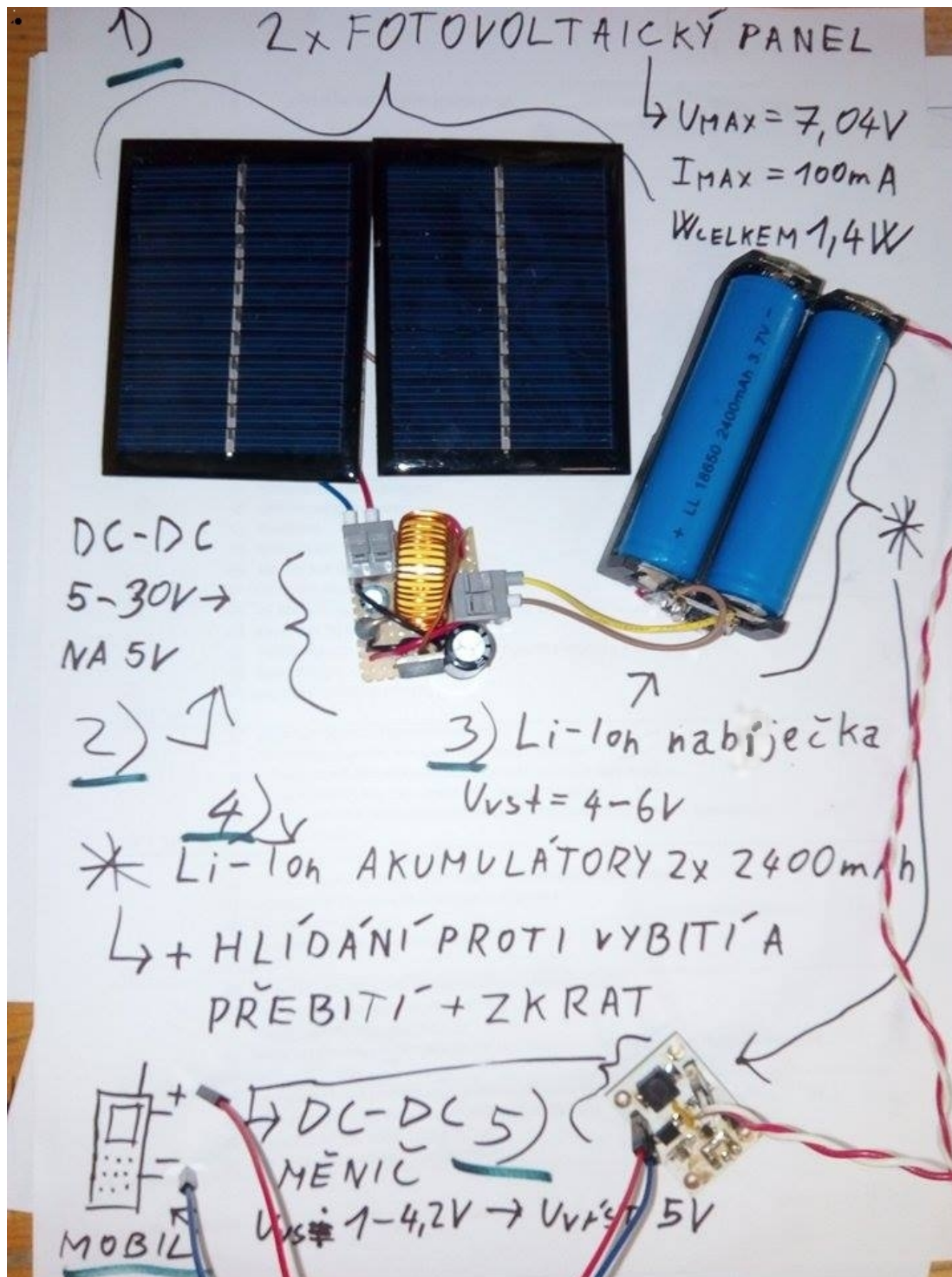
obr. 7 Funkce soběstačného zařízení
