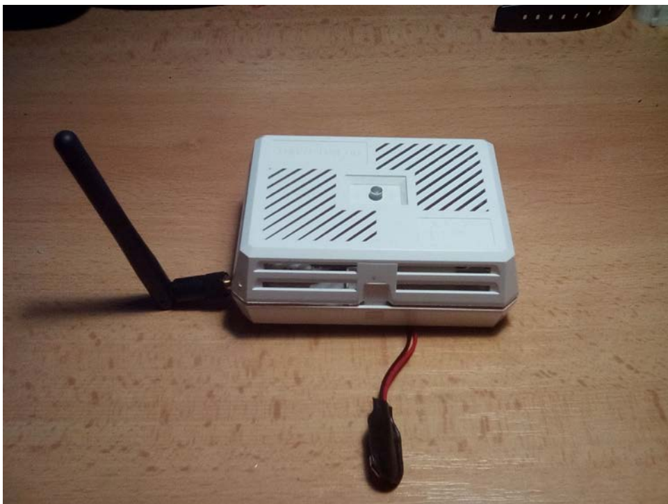
Obr.6) Modul se senzorem teploty a vlhkosti Autor: Aleš Chytrý
