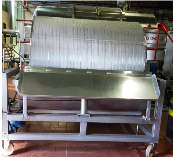
Obrázek č. 9: Vakuový rotační filtr (Zdroj: vlastní foto)
