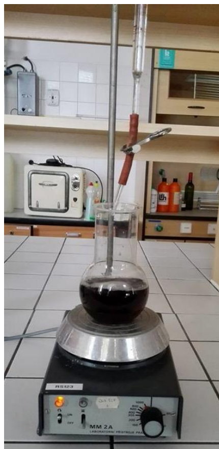
Obrázek č. 25, 26 :Titrační aparatura pro stanovení veškerých titrovatelných kyselin (Zdroj: vlastní foto)
