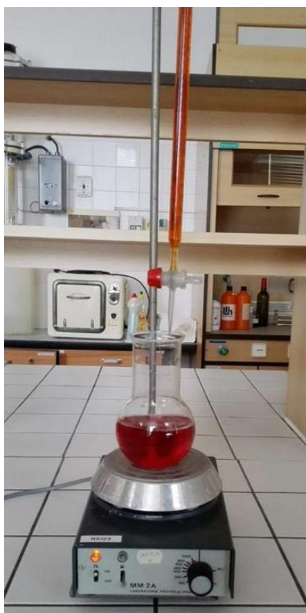
Obrázek č. 28, 29 : Titrační aparatura na stanovení SO_2 ve víně (Zdroj: vlastní foto)
