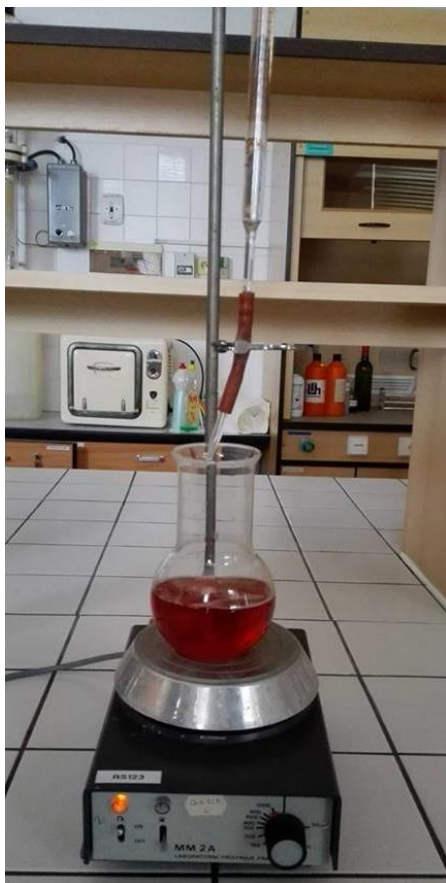
Obrázek č. 25, 26 :Titrační aparatura pro stanovení veškerých titrovatelných kyselin (Zdroj: vlastní foto)
