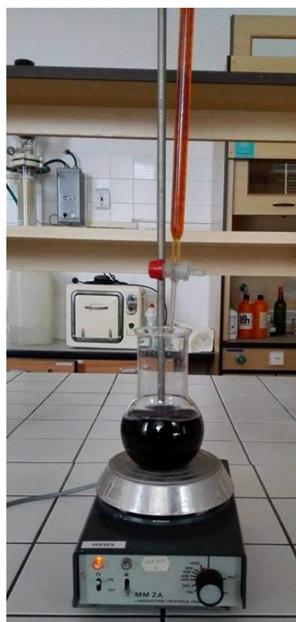
Obrázek č. 28, 29 : Titrační aparatura na stanovení SO_2 ve víně (Zdroj: vlastní foto)
