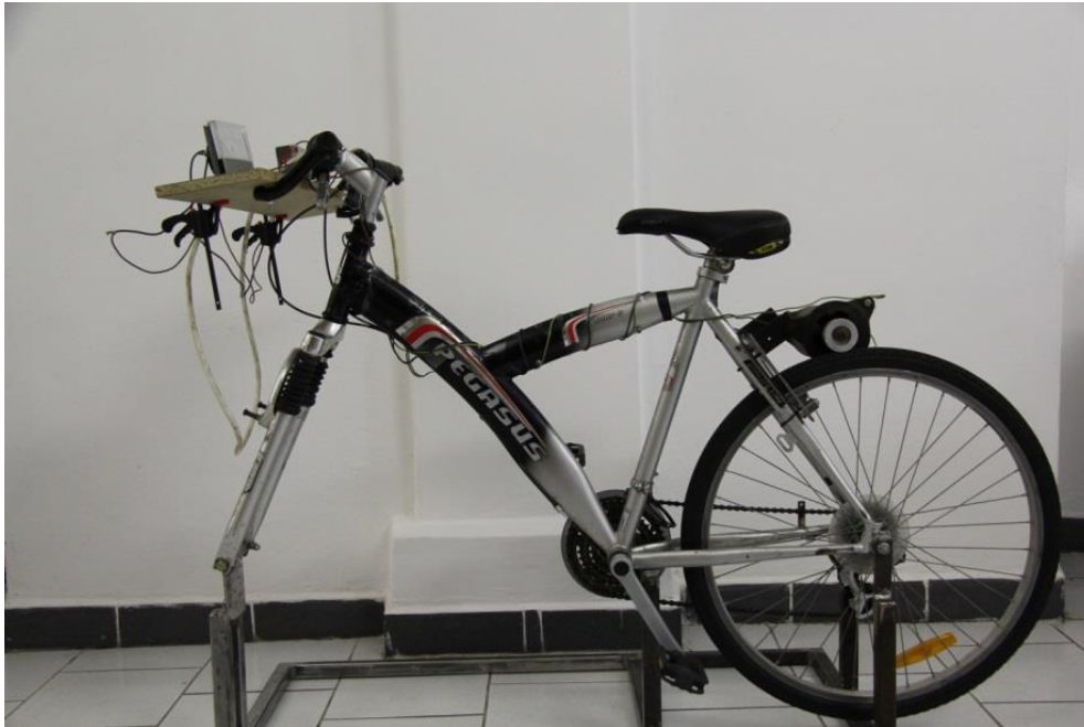
Foto kola s dynamem v době zkoušek
