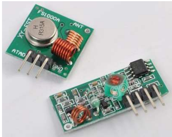
Obrázek 7: Vlevo je vysílač, vpravo přijímač
