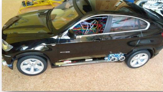
Obr. 2: Auto se zapojenými senzory a základní deskou Arduino
