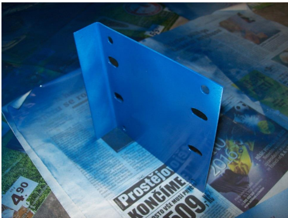
Obr. 17: Plech s drážkami, zde během lakování
