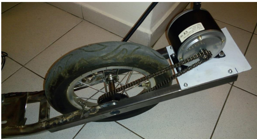
Obr. 4: Použitý motor, zkušebně namontovaný v jeho budoucí pozici
