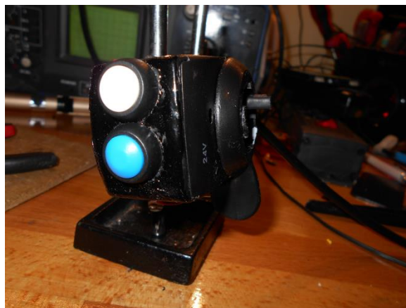
Obr. 12: Upravená plynová páčka (dvě přidaná tlačítka)
