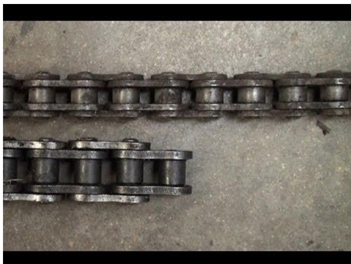
Obr. 15: Porovnání řetězů #35 (dole) a #25 (nahore) [3]
