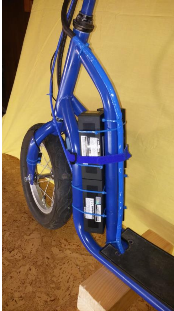
Obr. 18: Umístění a uchycení baterií v rámu koloběžky
