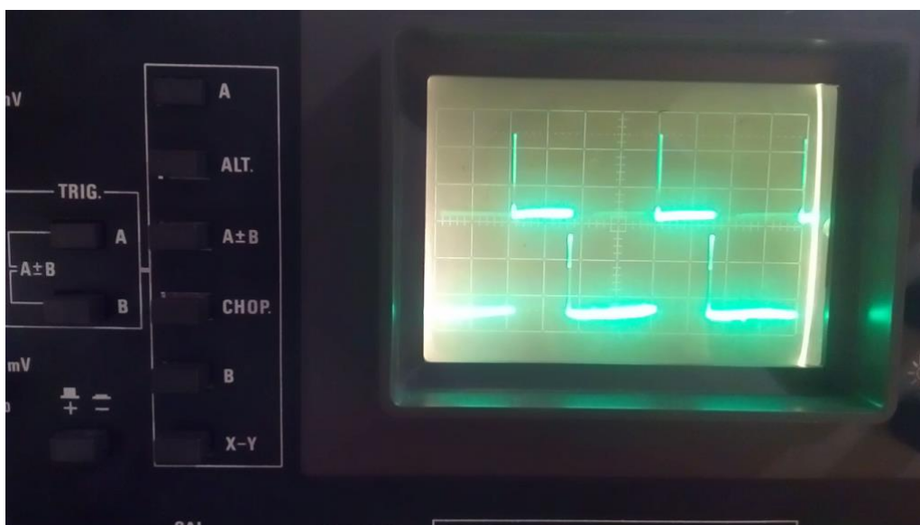
Obr. 8: Napěťové špičky tvořené motorem, zobrazené na osciloskopu
