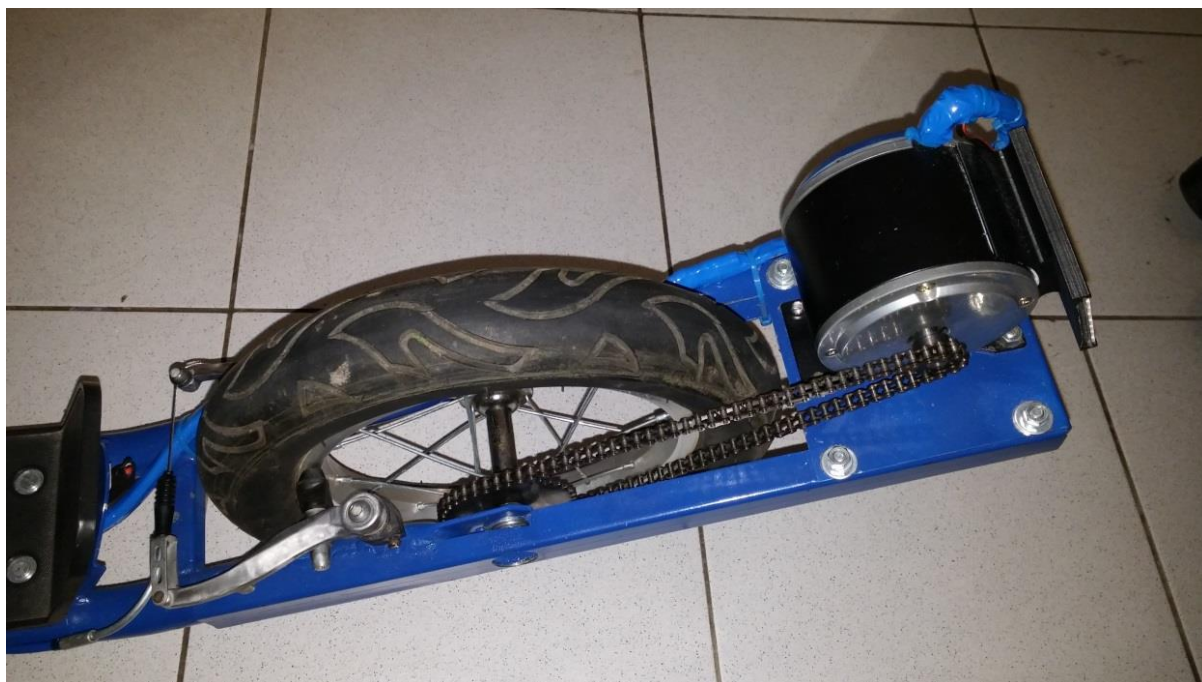
Obr. 16: Přichycený motor, již s napnutým řetězem
