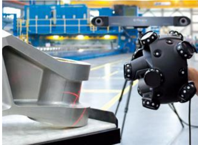
Obrázek 3 Bezdotykový 3D skener [14]
