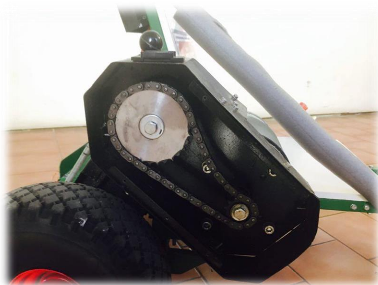
Obr. 5: Převodový poměr z motoru na kolo
