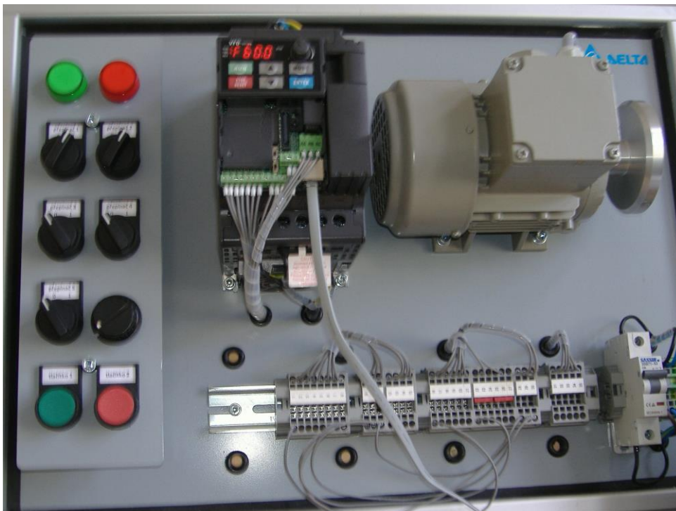
Obrázek č. 1. Konstrukční uspořádání přístrojů na desce
