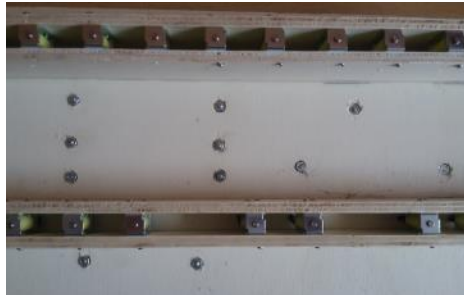
Obr. 8 Uchycení plošných spojů šrouby
