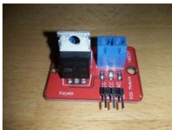
Obr. 10 Původní plošné spoje s tranzistory
