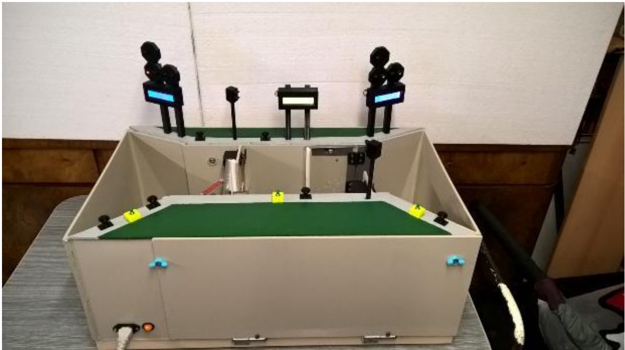
Obrázek 20 Hotový model automatického lodního zdymadla
