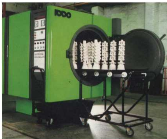
Obrázek 7- Vytavování vosku v boilerklávu
