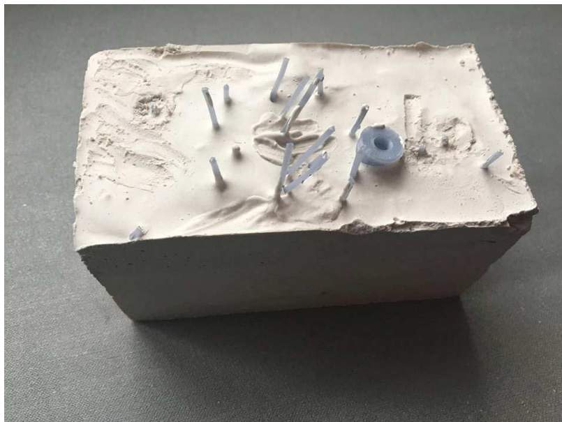
Obrázek 32- Forma po 30 hodinách schnutí
