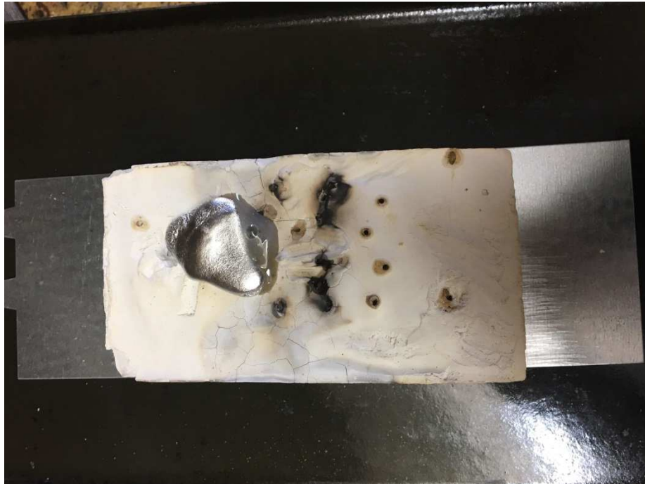
Obrázek 37- Únik materiálu MoldLay
