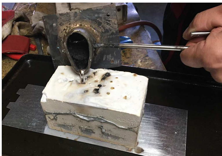
Obrázek 36- Lití cínu do formy
