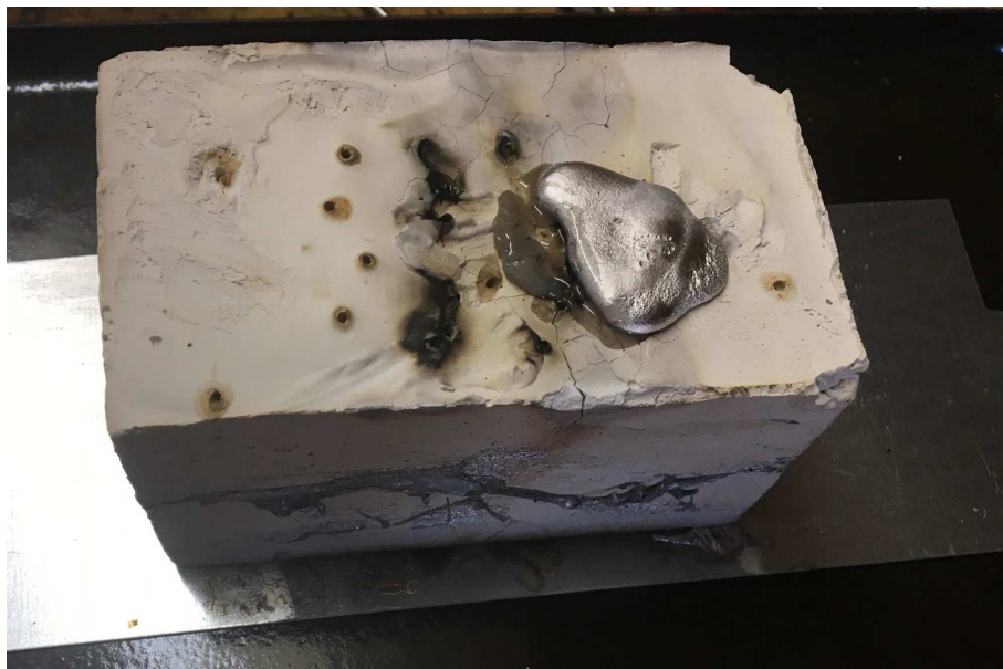
Obrázek 38- Únik materiálu MoldLay (2)
