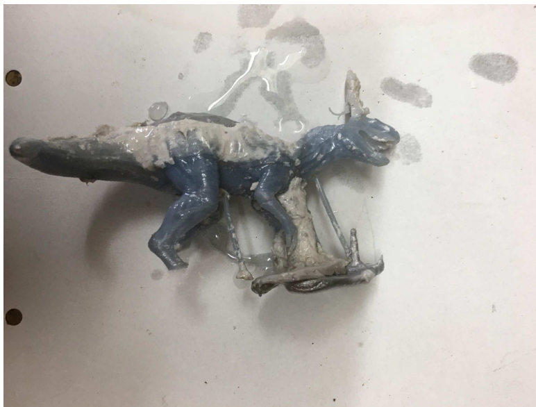
Obrázek 42- Oddělování odlitku po 15 minutách
