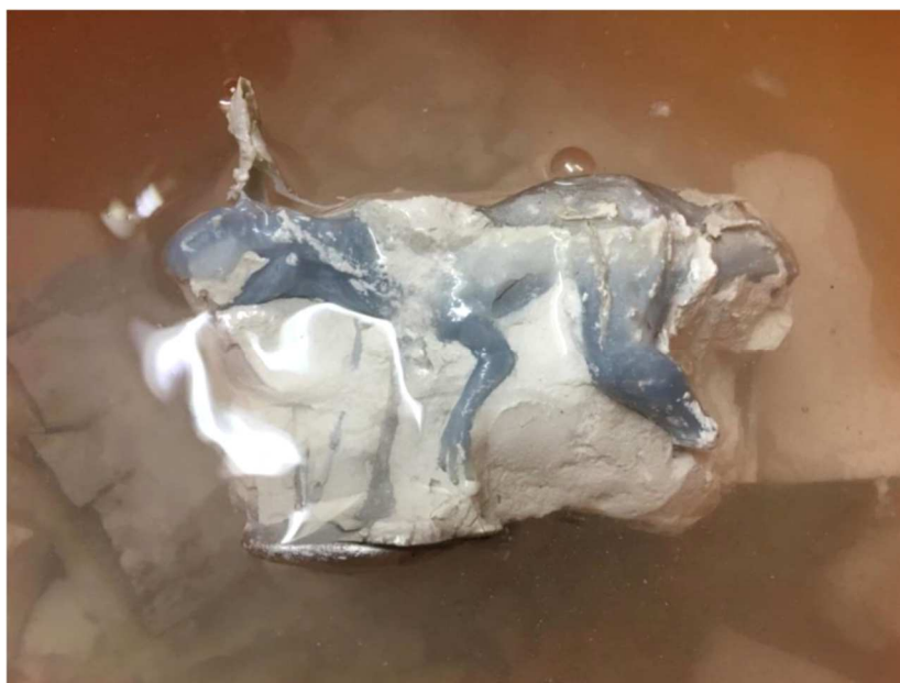
Obrázek 40- Oddělování odlitku po 4 minutách
