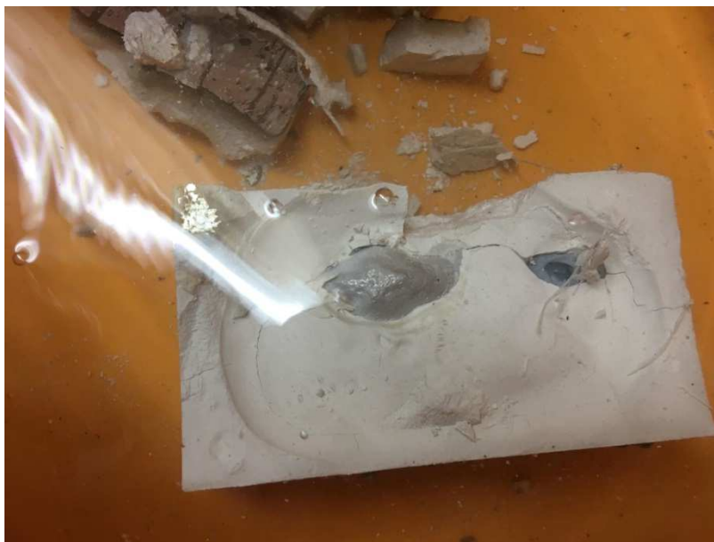
Obrázek 39- Oddělování odlitku po 1 minutě
