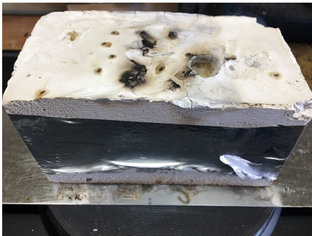
Obrázek 34- Forma zahřívána pomocí horkého vzduchu
