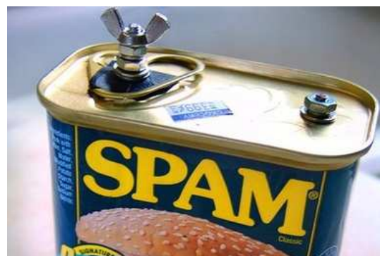
Obrázek 4 - Dírková komora vyrobená z plechovky
