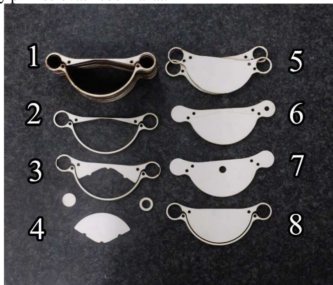
Obrázek 9 - Všechny již vygravírované díly dírkové komory
