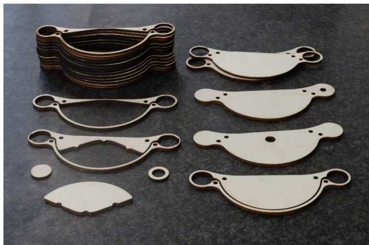
Obrázek 20 - Všechny potřebné díly k sestavení dírkové komory
