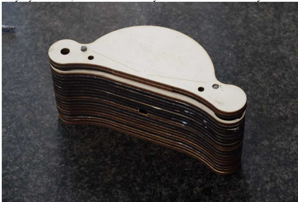
Obrázek 24 - Téměř složená dírková komora
