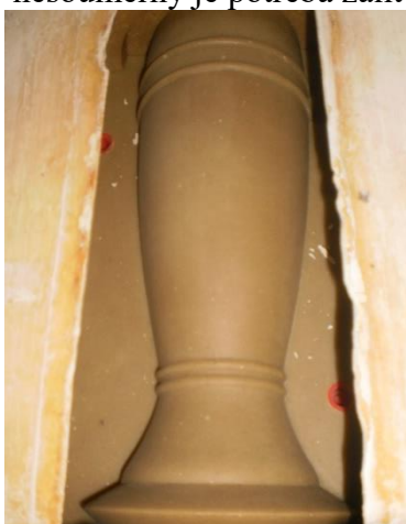
Obr. 4 Silikonové množítka na výrobu forem
