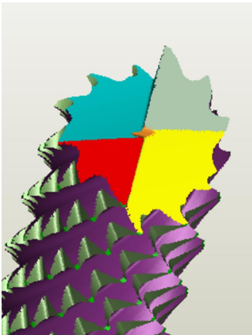
Obrázek 62 - 3D simulace, Vyšpicování (světle modrá), Vyšpicování V2 (žlutá), Kapsa na čele (oranžová), Hřbet na čele nástroje 1 (šedá), Hřbet na čele nástroje 1V2 (červená)
