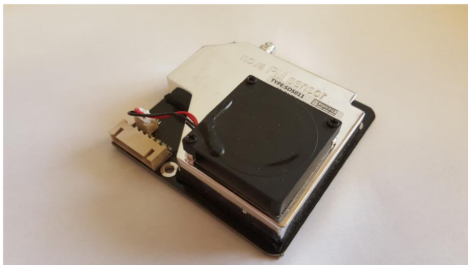
Obrázek 13: Senzor polétavého prachu PM10 a PM2.5 SDS 011. Foto autor
