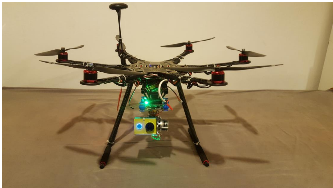
Obrázek 9: Obrázek 8: Sestavená hexakoptéra se všemi součástmi, kamerou, stabilizátorem obrazu a GPS. Foto autor.
