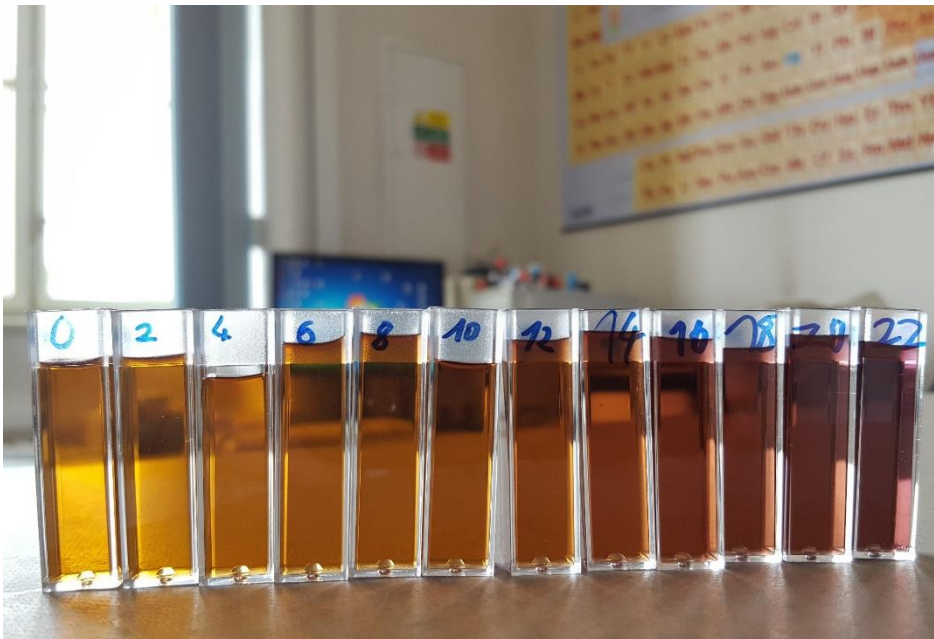
Obrázek 5: Kyvety s dozimetry po ozáření dávkami 0 – 22 Gy (zleva doprava) (autor)
