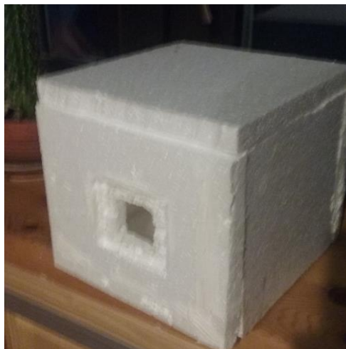
Obrázek 5- otvor pro článek se zářezy na chladič
