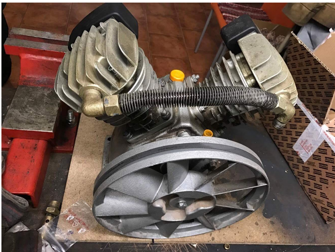
Obrázek 5 Základní stroj pístového kompresoru s poháněným kolem
