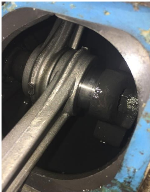
Obrázek 9 Kliková hřídel se setrvačnickem
