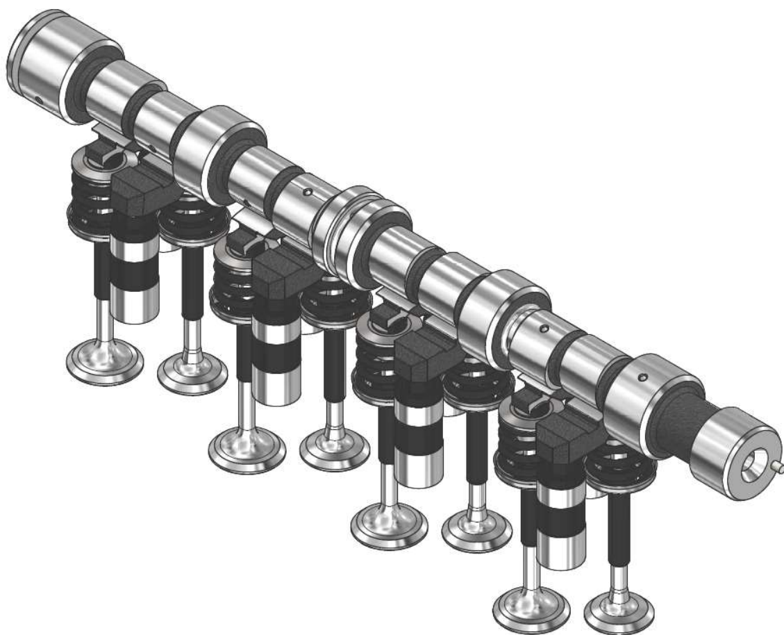
Obrázek 32 Model vačkové hřídele a sestavy ventilů
