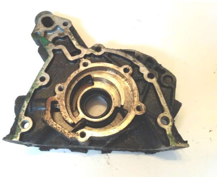
Obrázek 48 Skříň olejového čerpadla
