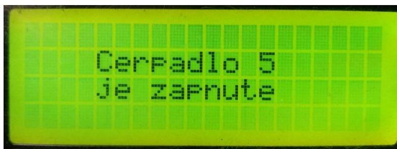
Obr. 53 Vypsání informace na displej při zapnutí čerpadla ze záložní nádrže
