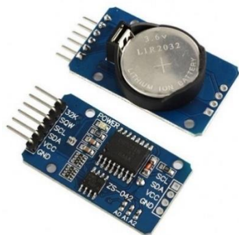
Obr. 20 Modul RTC DS3231 [7] Obr. 21 Zapojení modulu do Arduino Mega 2560 [7]
