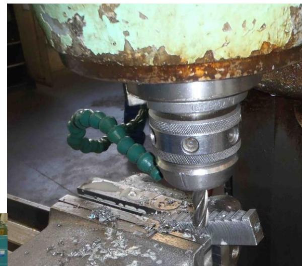
foto: výroba zarážky frézování úhlových drážek pomocí naklonění obrobku v přípravku ve svěráku
