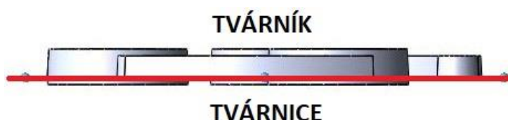
Obrázek 8: Návrh dělicí roviny; Vytvořeno v aplikaci Solidworks CAD 2017.
