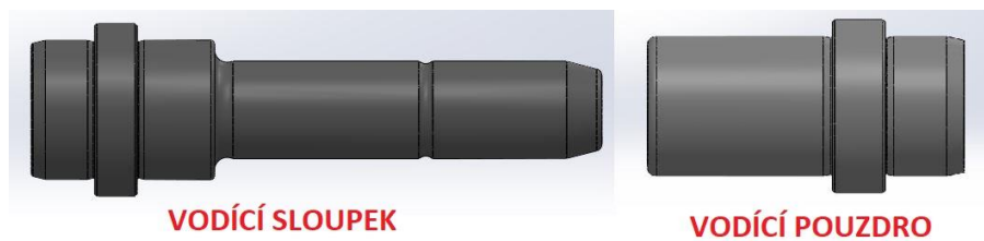
Obrázek 15: Vodící sloupek a vodící pouzdro; Vytvořeno v aplikaci Solidworks CAD 2017.
