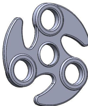
Obrázek 10: Zaoblení vylisku; Vytvořeno v aplikaci Solidworks CAD 2017.
