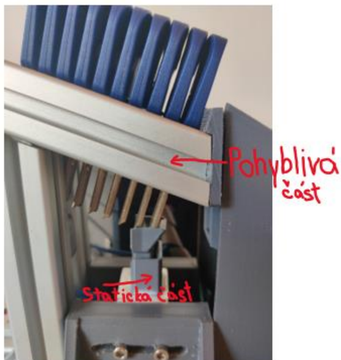
Obrázek 3 – řešení vykládání klíčů do stroje
