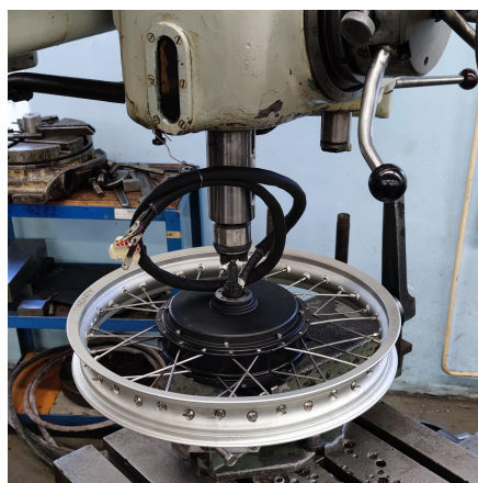
Obr. 4: Centrování zadního kola s elektromotorem
