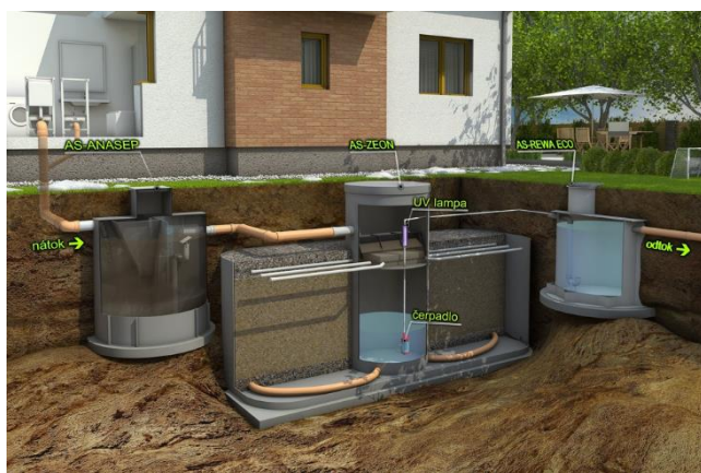
Obrázek 18: Domácí ČOV a využití vody na závlahu [36] na splachování toalety nebo zalévání.
