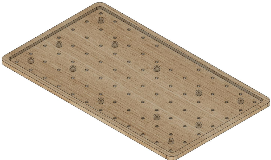
Obr. 7: 3D model spodní vrstvy se zúžením pro ochranu PCB – zdola
