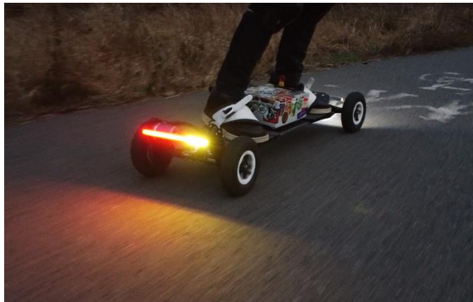
Obrázek 18: Testování směrových světel na elektrickém longboardu
