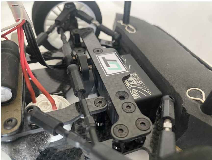
Obr.5: uchycení serva a přední náprava
