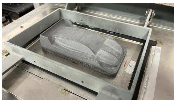
Obrázek 89: Kopyto v lisovacím stroji
