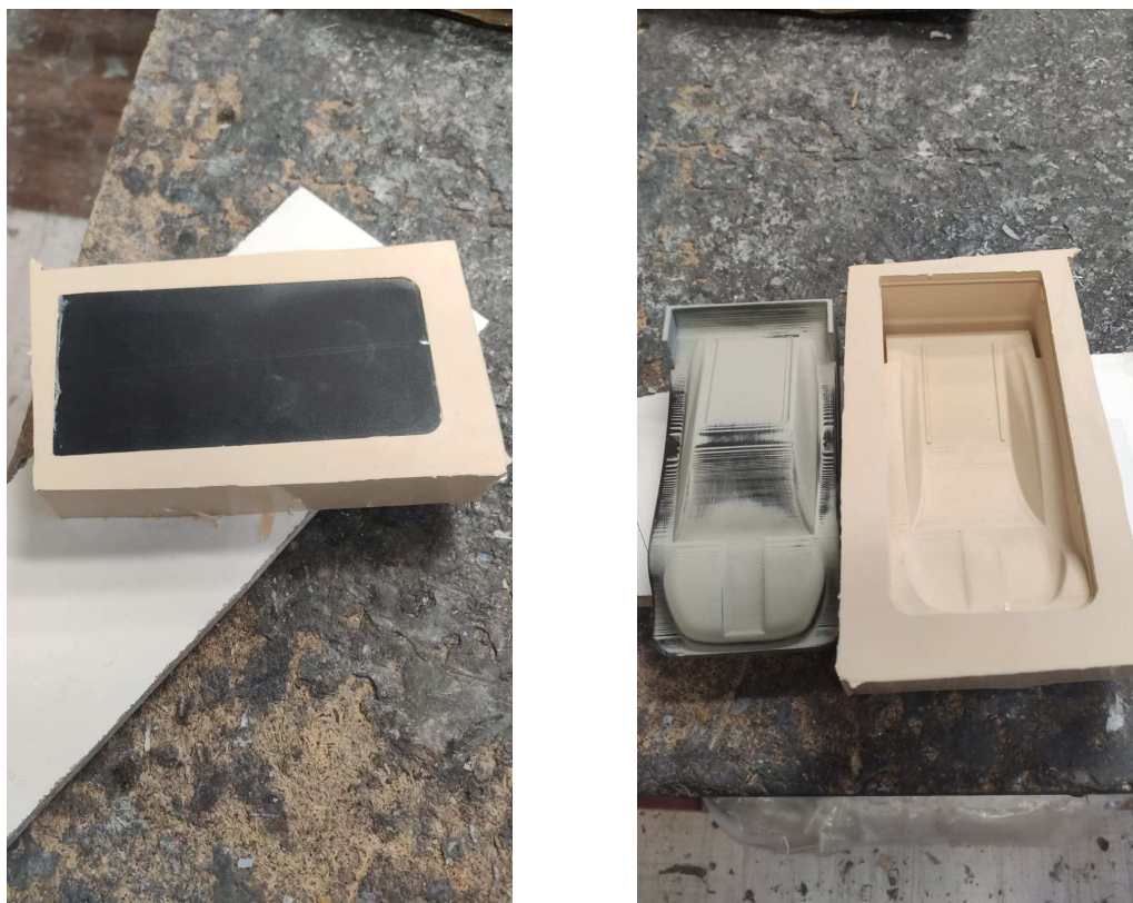
Obrázek 88: Vytvrzená negativní forma pro výrobu kopyta
