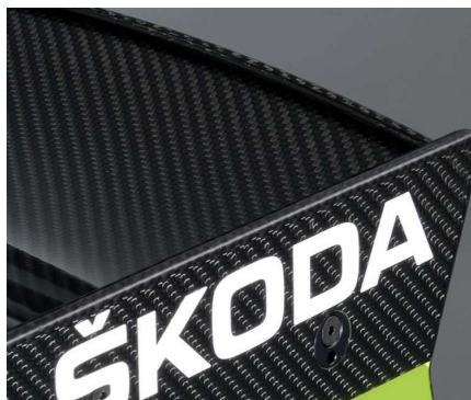
Obrázek 84: Zadní spoiler mé karoserie a přitlačné křídlo Škoda Fabia RS Rally2 [34]
