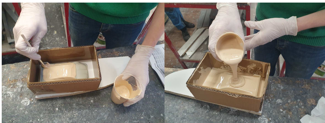
Obrázek 87: Zalití 3D výtisku do Lukoprenu N1522
