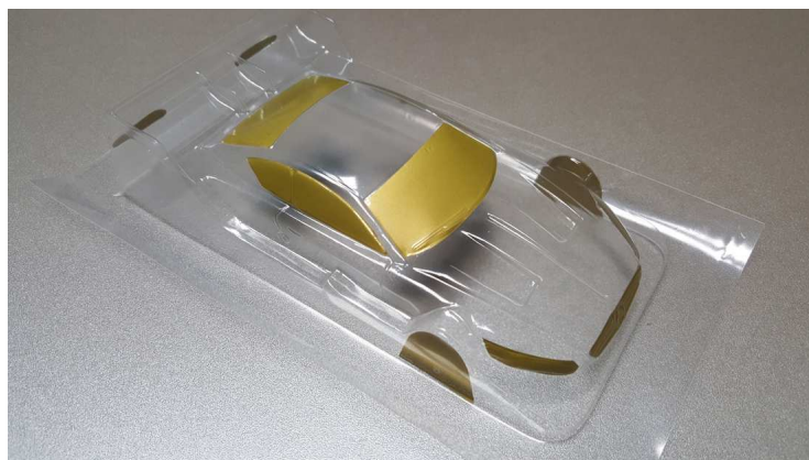
Obrázek 85: Vylisovaná karoserie Mercedes AMG C 63 DTM s nalepenými výlepkami oken [24]
