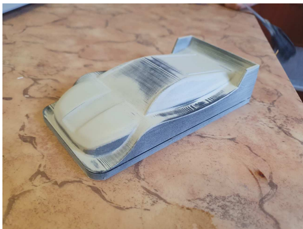
Obrázek 86: 3D výtisk pro výrobu negativní formy
