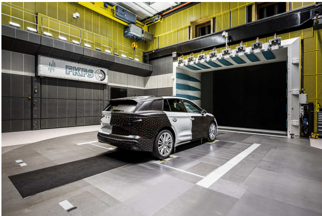
Obrázek 26: Aerodynamický tunel FKFS s testováním aerodynamiky Škoda Enyaq [22]
