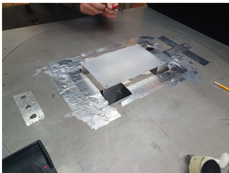
Obrázek 74: Připevnění modelu v aerodynamickém tunelu
