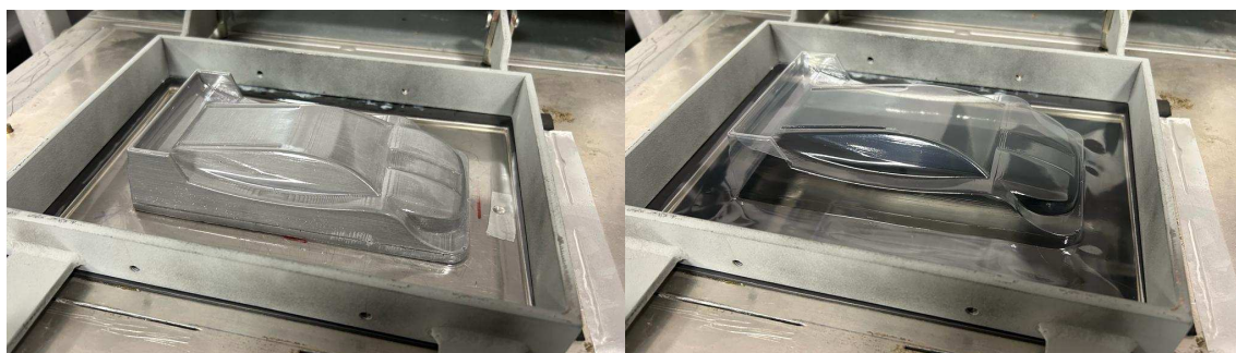
Obrázek 90: Kopyto po vylišování karoserie
