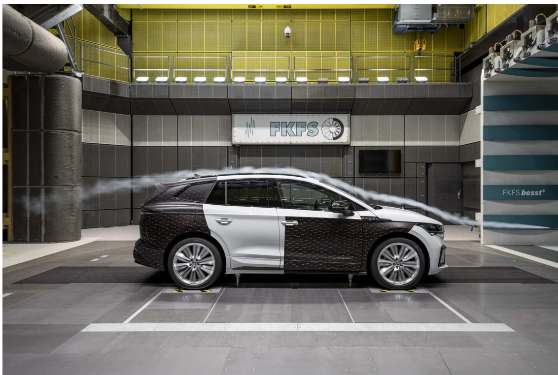
Obrázek 27: Aerodynamický tunel FKFS s testováním aerodynamiky Škoda Enyaq [22]
