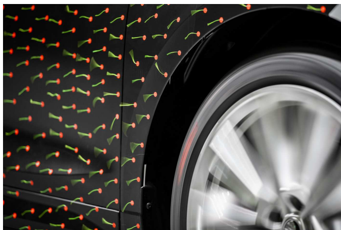
Obrázek 77: Škoda Enyaq s připevněnými bavlnkami pro znázornění proudění vzduchu [22]
