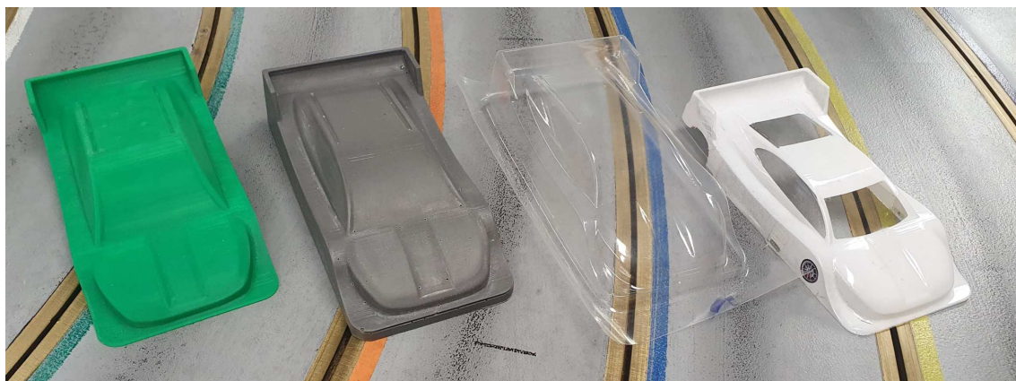
Obrázek 91: Vývoj výroby mé karoserie
