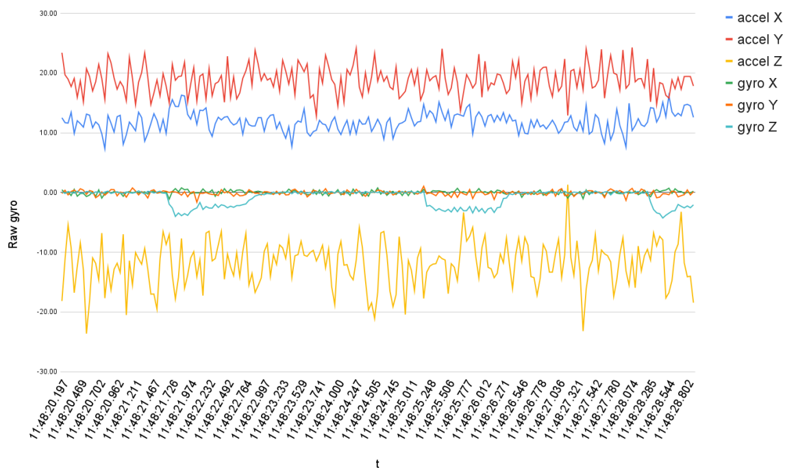
Obrázek 12: Graf měření č. 14. Toto měření probíhalo za konstantního signálu PWM 80 na vnitřní koleji autodráhy (Obrázek 10). Model auta jezdil proti směru hodinových ručiček. Pro lepší orientaci v grafu je křivka akcelerační hodnoty osy X posunuta o +10 bodů a křivka akcelerační hodnoty osy Y o +20 bodů.
