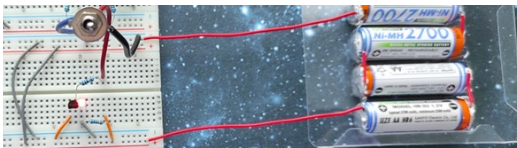
Obrázek 2.19: Logický člen NOT se vstupní hodnotou 0
