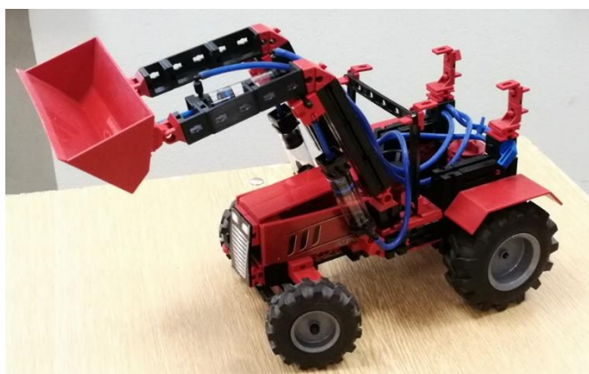
Obrázek 8 : Kolový bagr s pneumatickým ovládním ze stavebnice Fischer Technik
