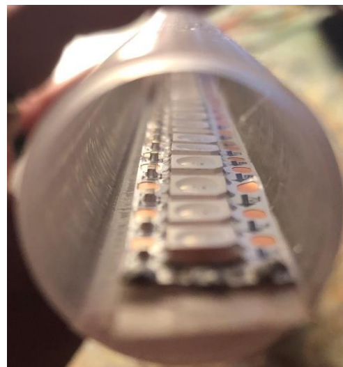
Obrázek 3: Náhled do krytu na osvětlení s RGB páskem
