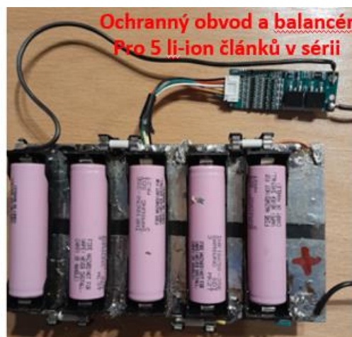
Obr. 6 Sestava nabíjecí baterie s Li-ion články a ochranným obvodem s balancérem
