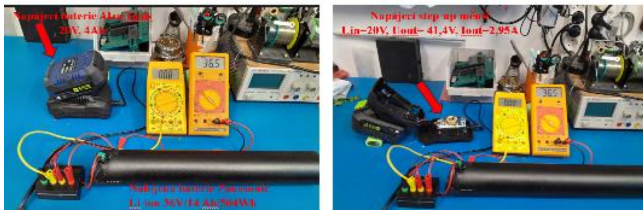
Obr. 3 Mobilní nabíječka 1. typ, měřicí pracoviště mobilního nabíjení
