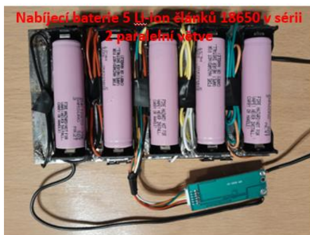
Obr. 6 Sestava nabíjecí baterie s Li-ion články a ochranným obvodem s balancérem
