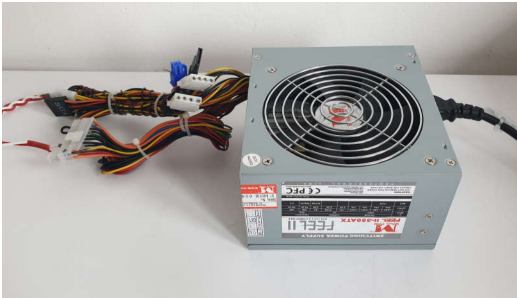
Obrázek 2: Napájecí zdroj z počítače
