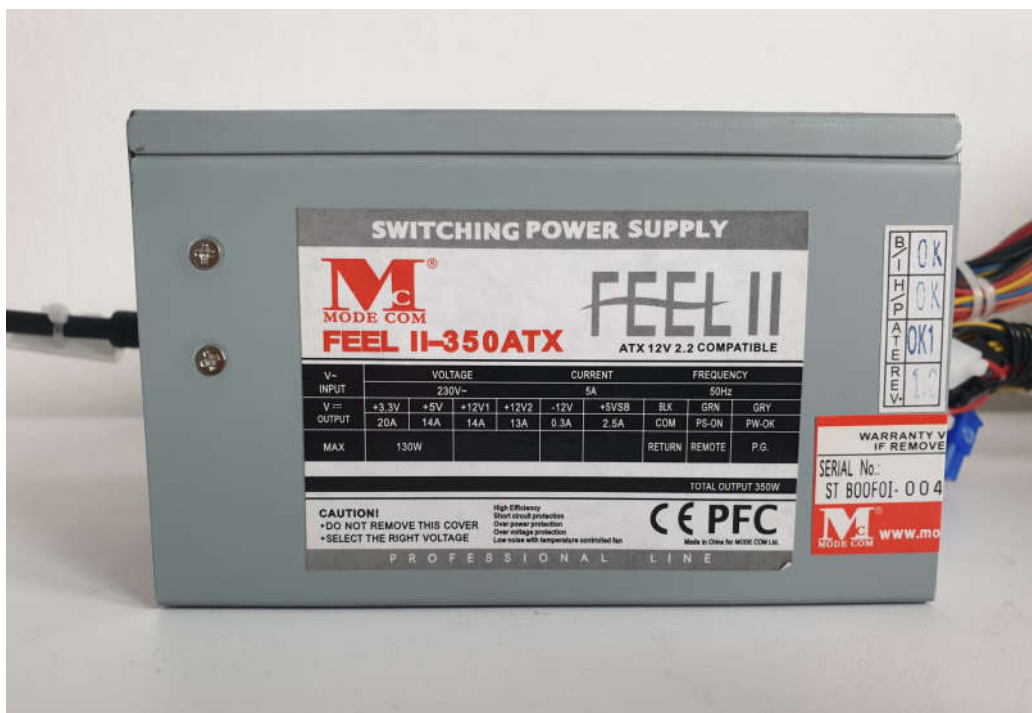
Obrázek 3: Napájecí zdroj z počítače
