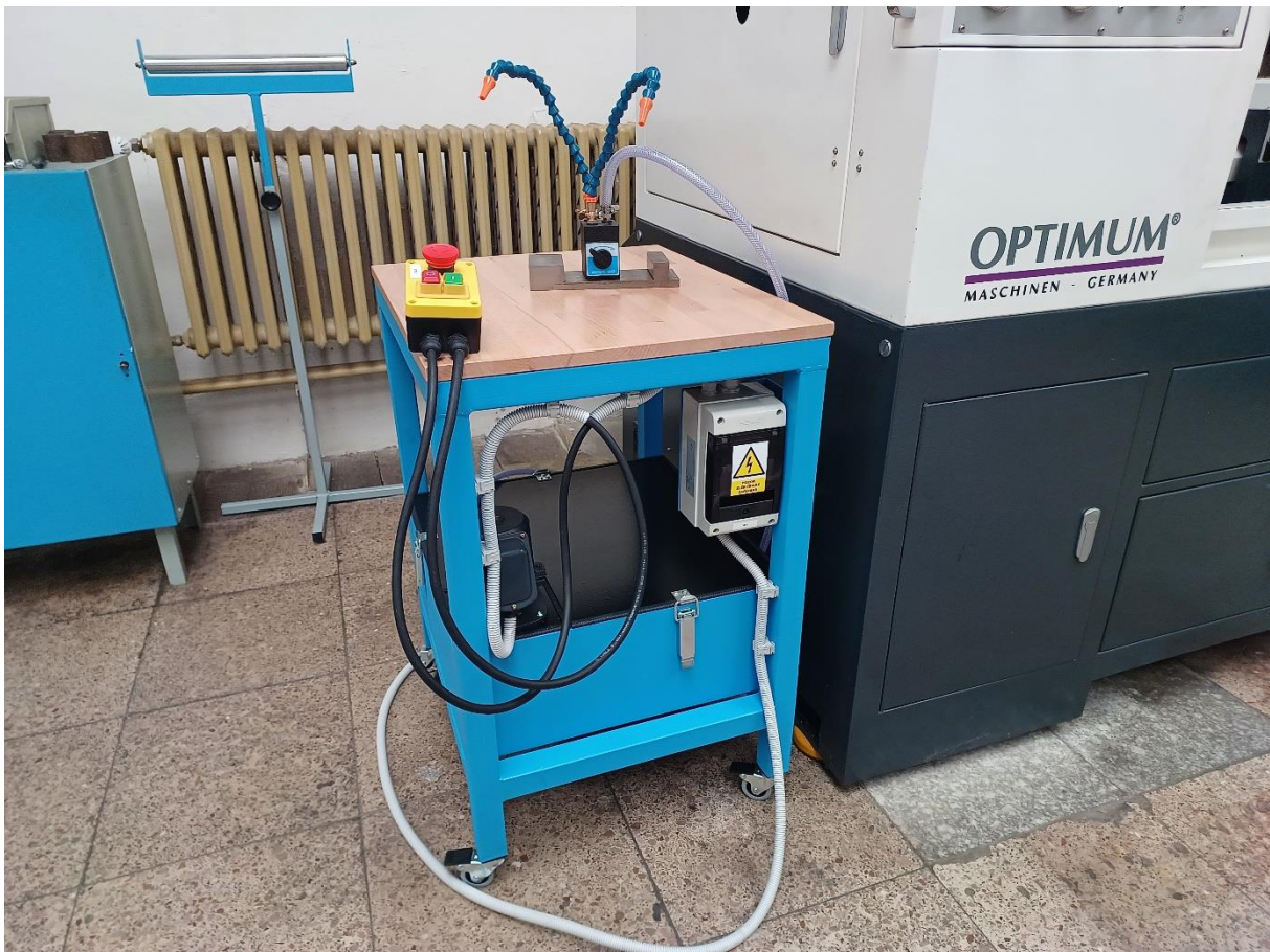
Obr. 1: Vyrobené mobilní chladicí zařízení v dílně strojního obrábění
