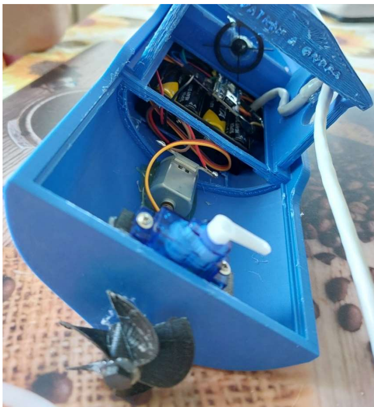
Obr. 22: Model lodičky rozpracovaný s elektronikou a lodním šroubem
