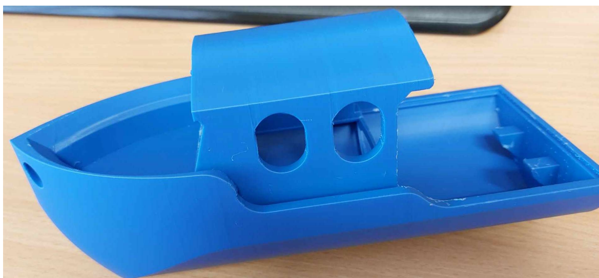
Obr. 17: Vytisknutý model po odstranění podpěr
