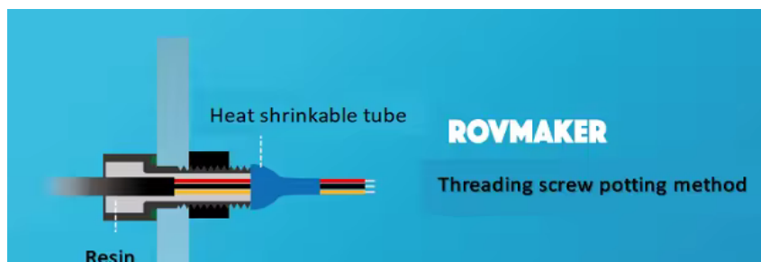
Obr. 9: Schematické znázornění penetrátoru (rovmaker.com, upraveno)
