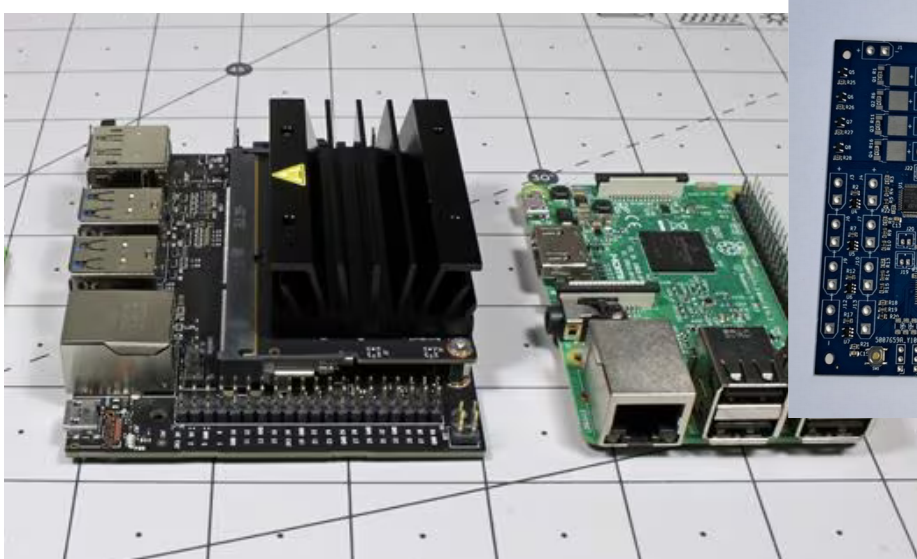
Obr. 15: Porovnání velikosti NVIDIA JetsonNANO s RaspberryPi 3B+ ( www.arrov.com , upraveno)
