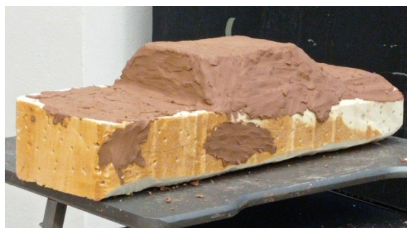
Obrázek 20 Nanášení hlíny na jádro
