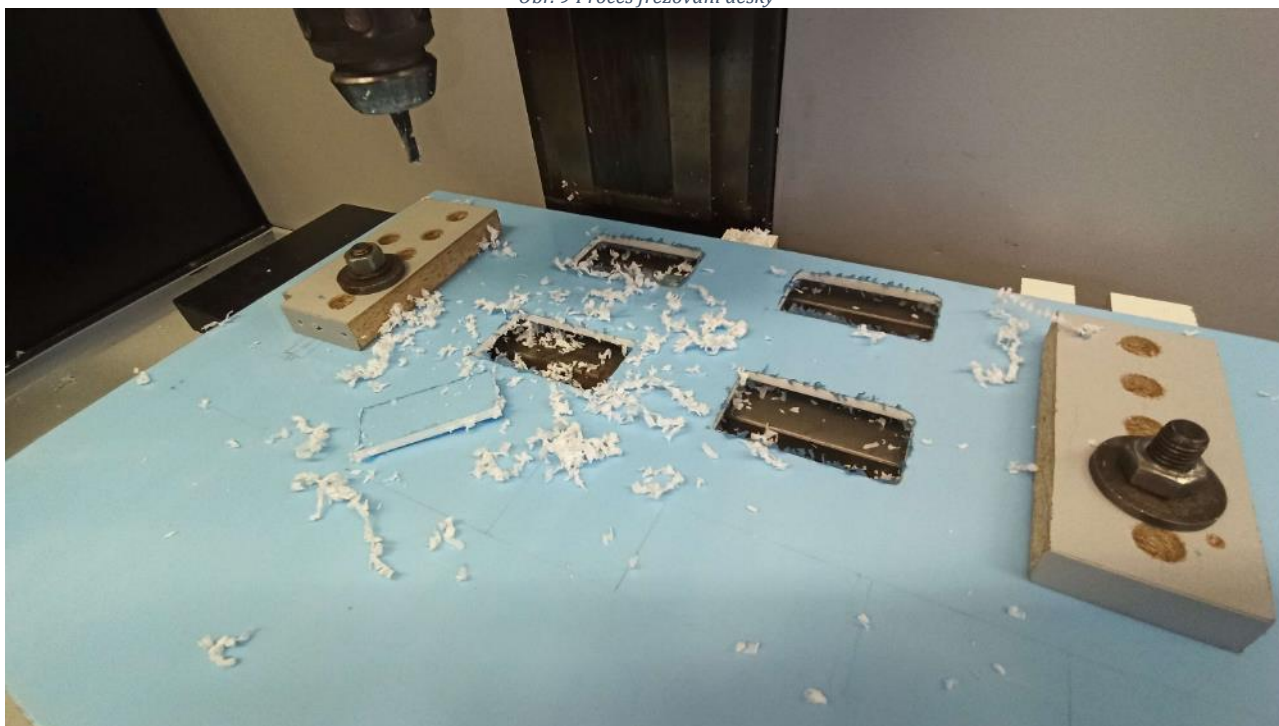
Obr. 9 Proces frézování desky
