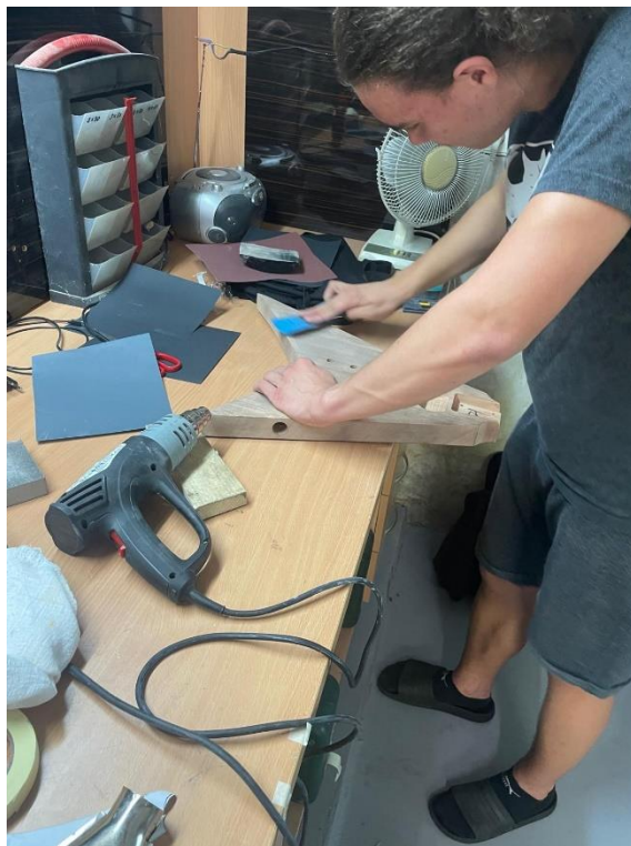
Obr. 2: Broušení těla kytary
