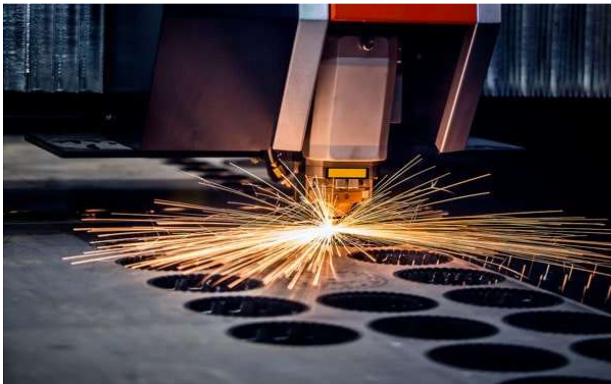
Obr.14- Ukázka řezání laserem
