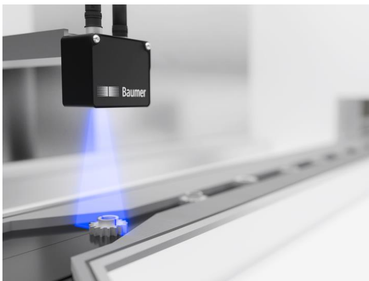
Obr. 24 - Ukázka laserové kontroly kvality ozubených kol (ajptech.cz)
