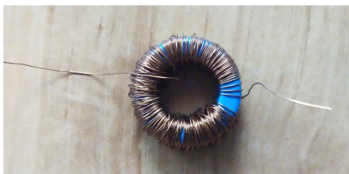
Obrázek 16: Ručně navinutá tlumivka o ~ 210 závitů
