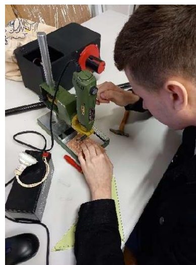
Obrázek 12a – Vrtání plošného spoje
